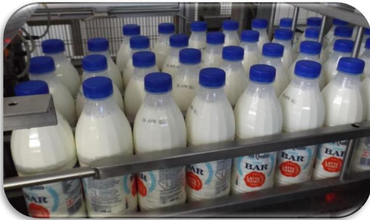
Il medesimo ciclo di lavorazione, soffiatura, riempimento ed etichettatura, viene realizzato in un'altra serie di macchinari in grado di produrre il formato da mezzo litro.
