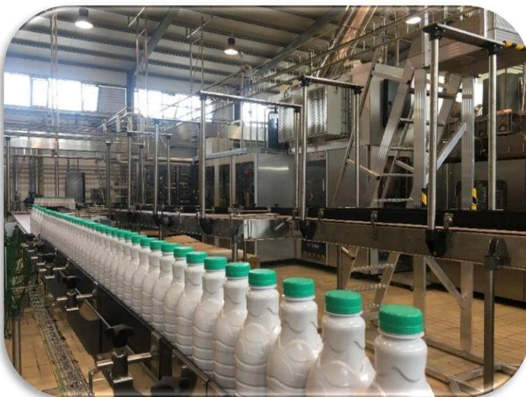
bottiglia proseguendo nel proprio cammino, viene ceduta alla stella di trasferimento, e da questa alla giostra del tappatore a vite per essere tappata. I tappi sono sospinti in avanti dalla tramoggia con soffi d'aria filtrata. L'operazione di etichettatura viene preceduta da una fase di asciugatura. L'etichettatrice a funzionamento
